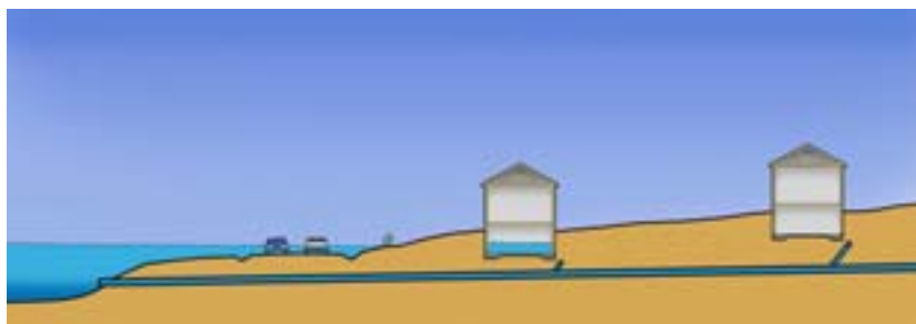
Figur 4.35 Mycket höga vattennivåer med dämnda servisleddningar och översvämmade källare
