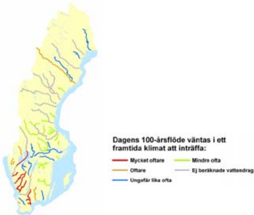
Figur 4.27 Förändrad frekvens av dagens 100-årsflöden i oreglerade och lågt reglerade vattendrag 2071–2100. Kraftigt reglerade vattendrag ingår ej (bilaga B 14)
