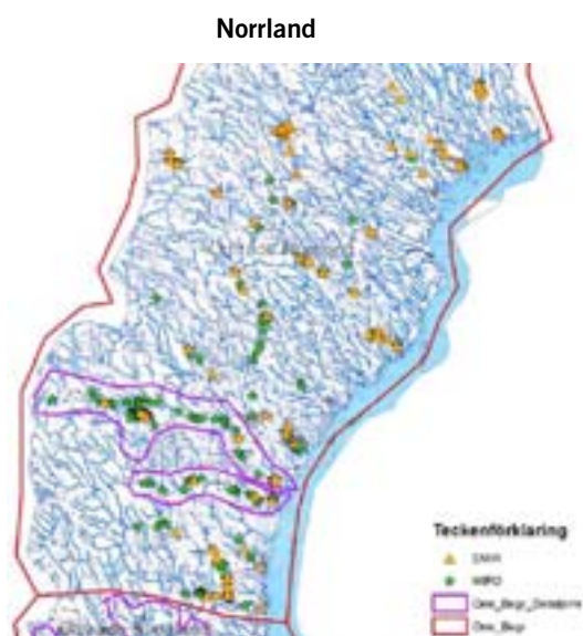
Figur 4.36 Pågående miljöfarliga verksamheter (EMIR) och förorenade markområden (MIFO) inom riskområden för översvämning, dagens 100-årsflöden
